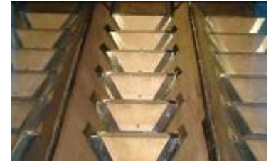
写真1 台形断面魚道模型
