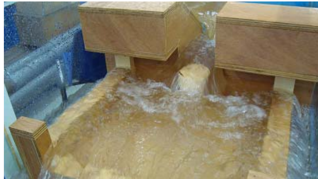
写真4 Q = 1.9\text{ m}^3/\text{s} 時のスリット周辺の流況
