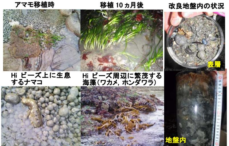
図5 広島湾宇品地区の海岸に施工したHiビーズ基盤実験区(浅場での生物棲息場の造成技術)にできた生態系と海藻が繁茂した場でのHiビーズ基盤の状況, 実験区では1m/sを超える航跡波と干出するアマモにとって好ましくない条件ではあるが, アマモの定着のみならず, Hiビーズ基盤境界には多量海藻が繁茂した。アマモの定着した周辺の地盤上には粗粒分が堆積するとともに, 細粒分はHiビーズ基盤内に沈降している。
