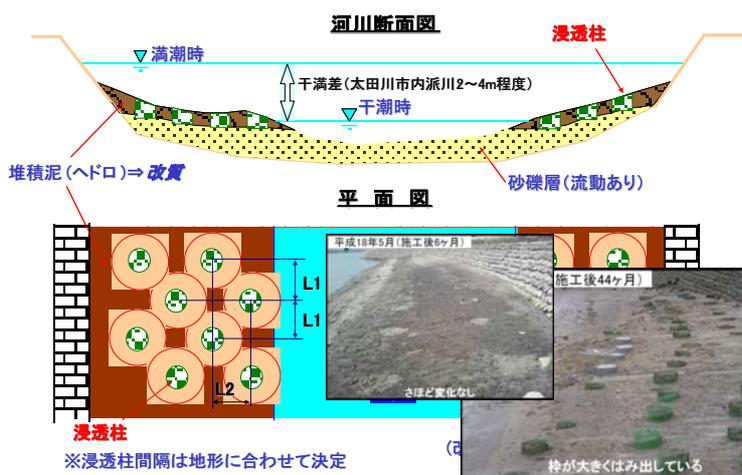
図2 河岸に堆積したヘドロの浄化技術、浸透柱は生物が生息できないヘドロ地盤内に酸素を供給し、生物の生息を促進する技術である。挿入写真はヘドロが約50cm堆積した旧太田川河岸に施工した浸透柱の施工後6ヵ月後と44ヵ月後の状況、44ヵ月後にはヘドロが浄化され歩行可能となった(中国電力施工)。
