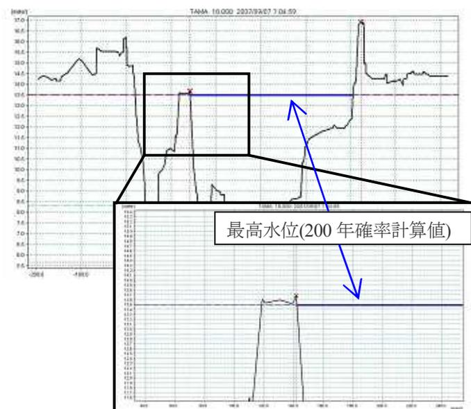
図5-200 年確率のシミュレーションにおける 18000m地点の断面図と拡大図 9 月 7 日 7 : 30 時点
