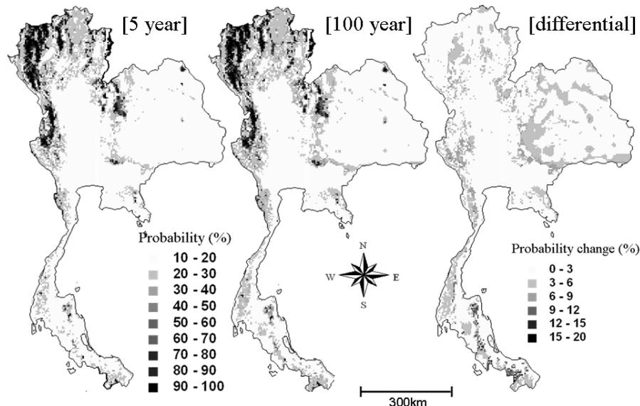
図2 各再現期間における土砂崩壊発生確率およびその差
