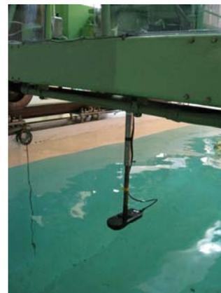
写真 1 試験設備および流速計設置状況
