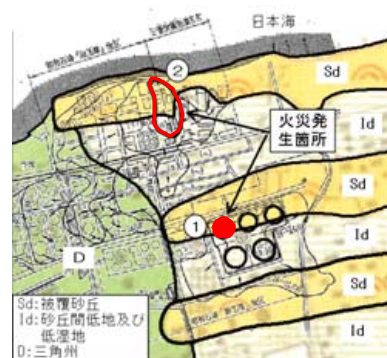
図 1 昭和石油タンクの火災発生位置(①:第 1 火災, ②:第 2 火災) 1) と地盤 2)
