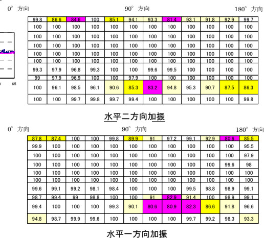
図7 躯体のせん断剛性残存率の比較
