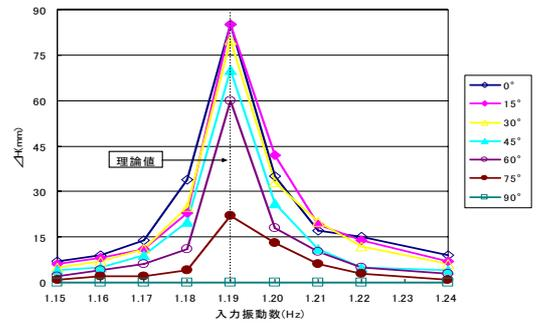
図-2 1.3:1貯槽入力振動数-最大波高関係
