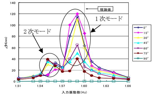
図-3 3:1貯槽入力振動数-最大波高関係
