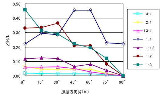
図-4 加振方向角-最大波高/Lの関係
