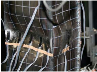
写真-1 座屈変形の様子
