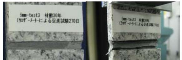
写真-1 材齢30年の引張試験前・破断時の試験体
