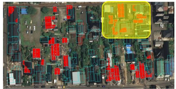
図-5 事前画像のみブレークラインを使用した場合の抽出結果 (右上は地震後DSMのエラーが大きいエリア)
