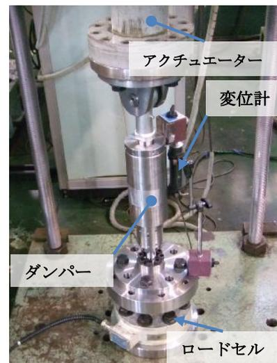
写真 1. ダンパー特性試験状況
