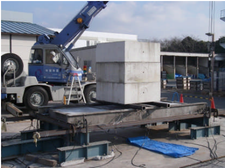
写真 3.1 載荷試験の状況
