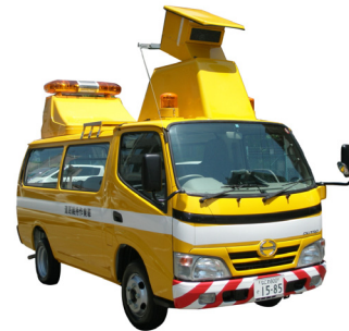
写真-1 路面計測車
