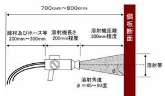
図-3 溶射ガンの作業イメージ図
