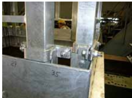
写真-3 試験体③（上下部固定）
