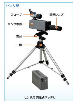
図1 レーザードップラー速度計
