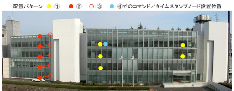
図-5 無線通信実験におけるセンサノードの配置
