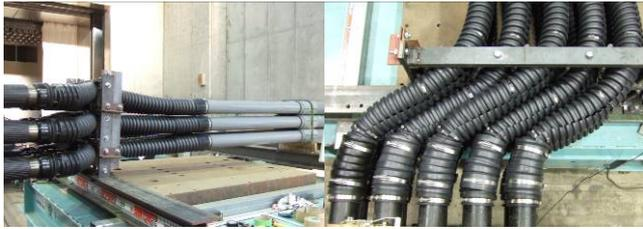
図5 多条多段の性能確認状況(左:3条3段 右:5条2段)
