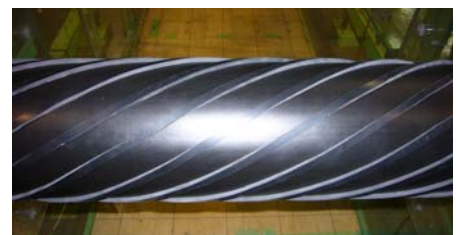
Fig.4 スパイラル(5x7.5mm)12本( \gamma=27^\circ )模型
