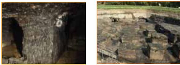
図1 岐阜県御嵩町亜炭坑廃坑による地下空洞
