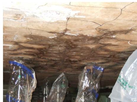
図3 疲労実験 (はく離進展後の漏水)
