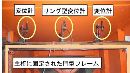
図-5 床版下面の変位計設置
