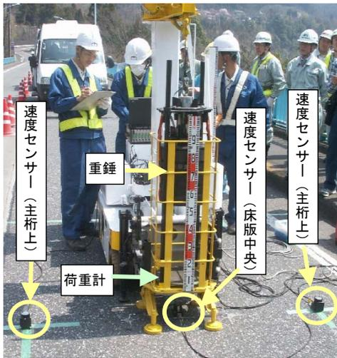
図-3 IISによるたわみ計測
