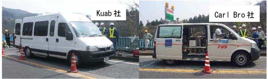
図-4 FWD (重錘落下装置を車内に備えている)
