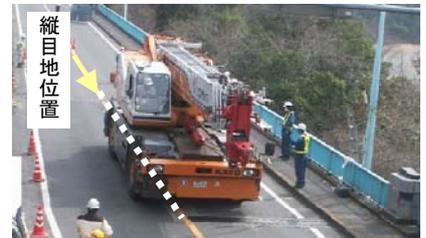
図-6 荷重車によるたわみ計測
