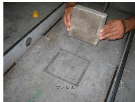
写真-1 空隙部の再現状況
