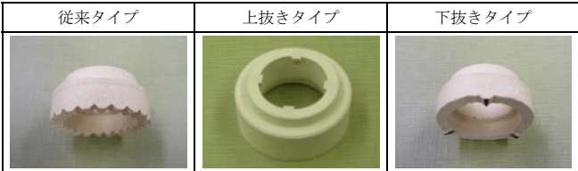
写真-1 各タイプのフェール形状
