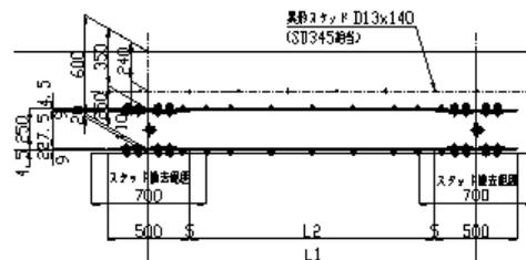
図-3 W鋼製型枠基部平面図
