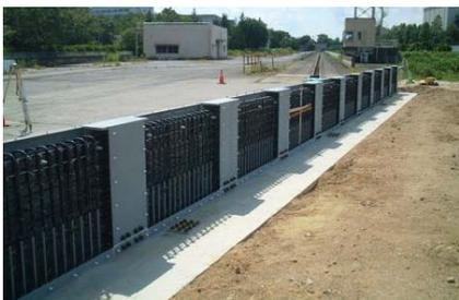
写真-6 衝突実験試験体配筋
