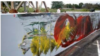
写真-8 衝突実験後のW鋼製型枠
