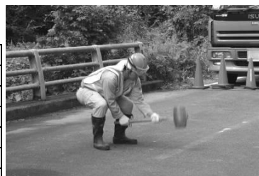
写真 1 木槌による加振状況
