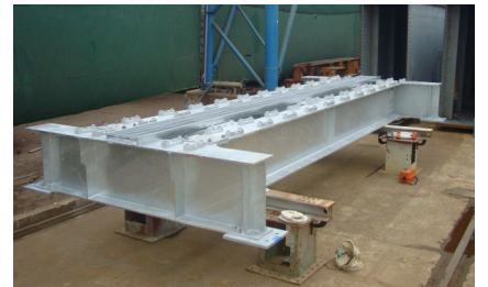
写真-2 新桁の外観（製作完了）
