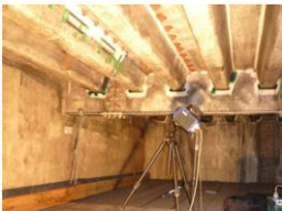
図1 赤外線計測風景 図2 屈曲き裂(磁粉探傷結果)
