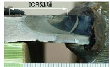
図-5  $N_{10}+ICR$  の疲労破面
