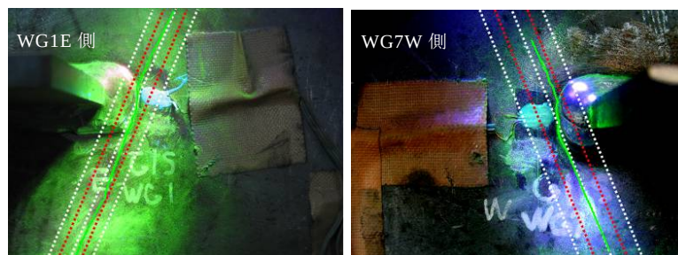
図-8 き裂進展性状（主応力方向一定部）
