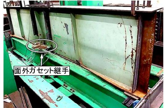
図1 疲労試験用試験体
