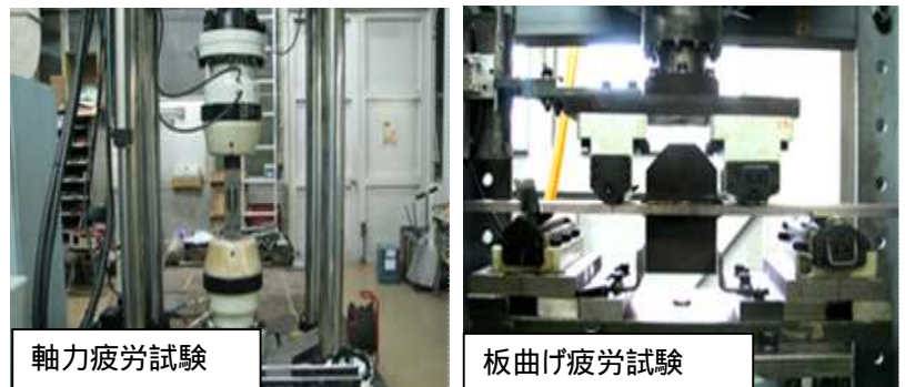
写真 1 疲労試験状況
