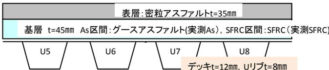
図-1 実橋の舗装構成
