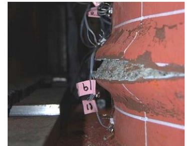
写真-1 実験後の供試体損傷状況
