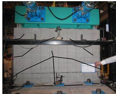
写真-2 損傷状況（ウイング有り・土留め壁有り）
