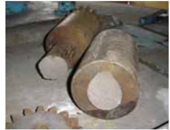
写真-1 破断したローラー
