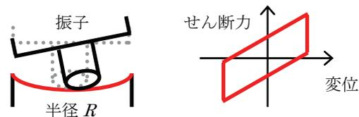
図-1 摩擦振子型免震支承の模式図
