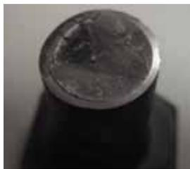
図-5 スリット型ボルトの破断面
