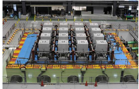
図1 震動台設置状況
