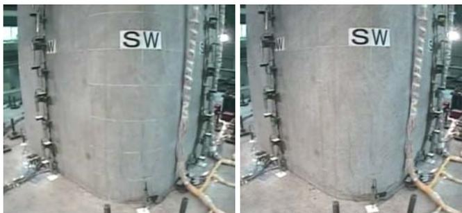
2回目(JR鷹取波100%加振終了時) 3回目(JR鷹取波100%加振終了時)
