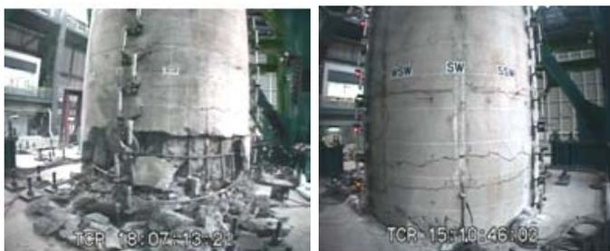
2回目(JR鷹取波100%加振終了時) 2回目(JR鷹取波100%加振終了時)
