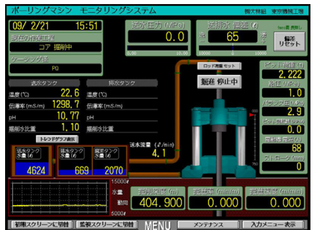
図 1 掘削モニタリングシステムモニター画面
