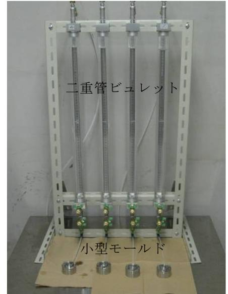
図1 透水試験装置
