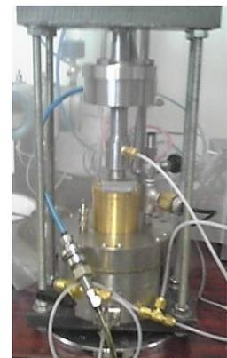
図-1 サクシオン制御型圧密試験装置
