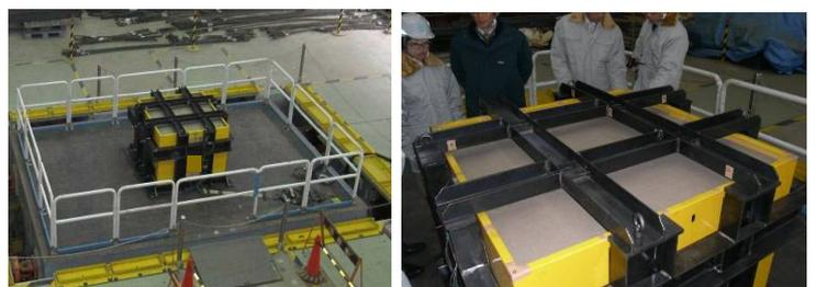
図-7 実物大金属製廃棄物収納容器と大型振動台装置
