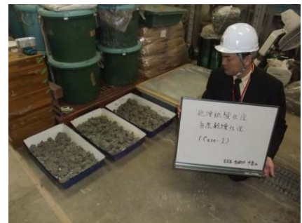
写真-2 乾燥試験状況(自然曝気)
