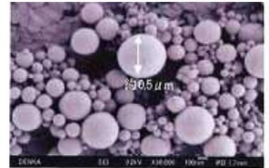
写真-1 超微粒子球状シリカの電子顕微鏡写真
