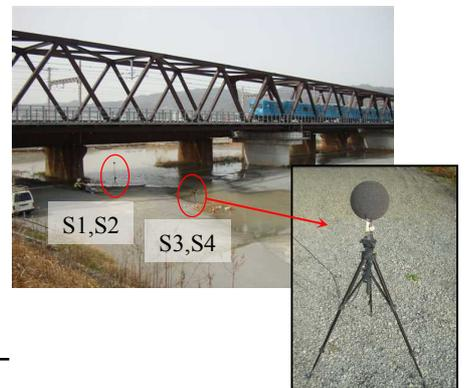
写真-3 計測機器設置状況
