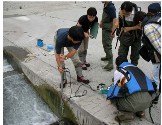
写真4 三次元流速計を用いた流況の確認
